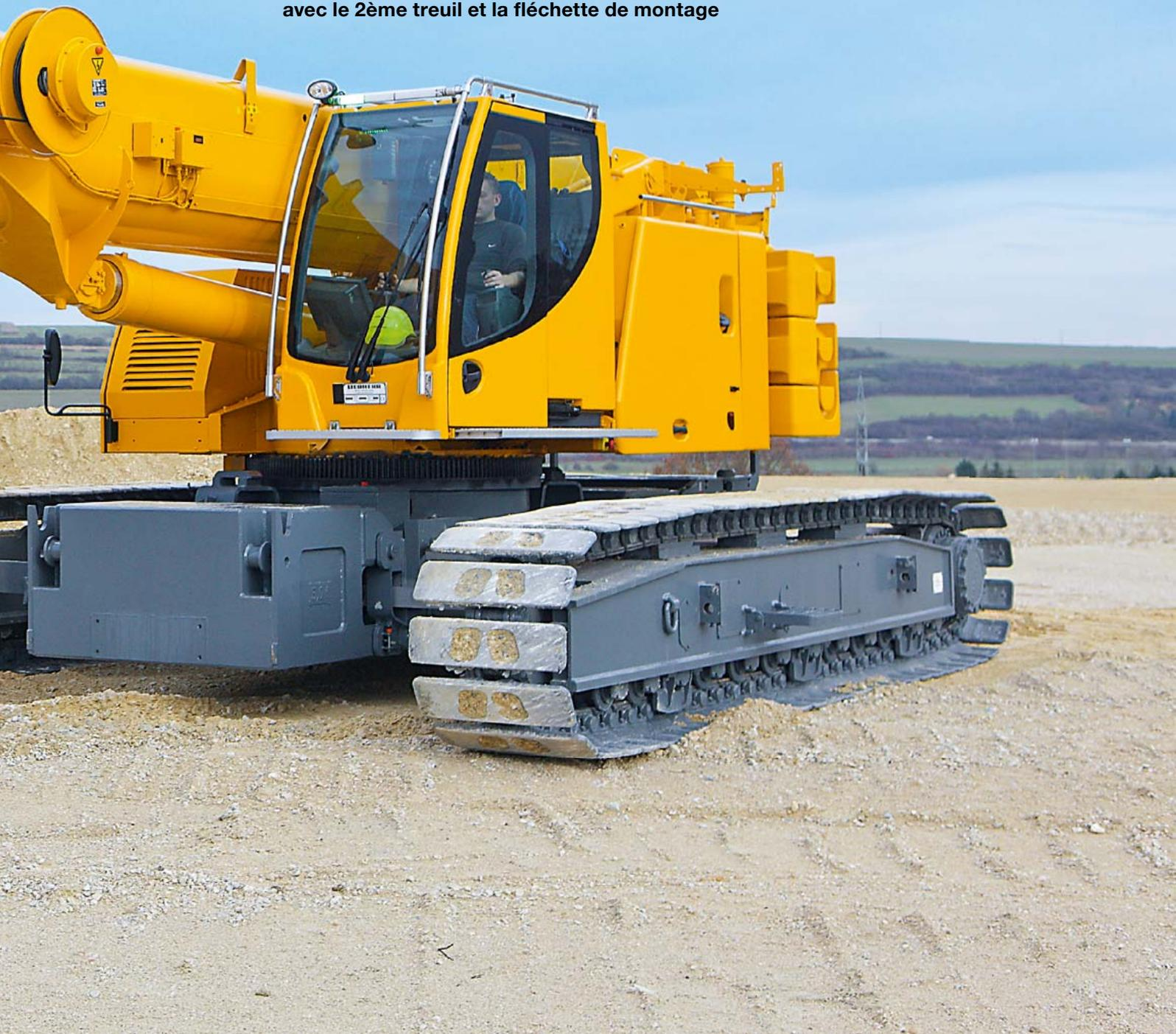
**Exemple de transport, grue avec contrepoids complet**
